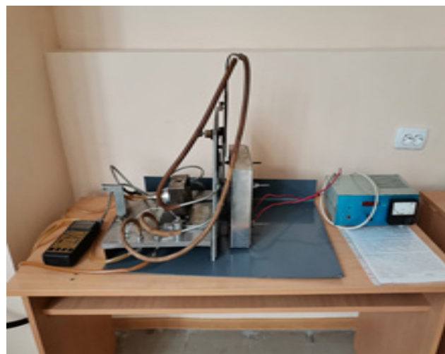
Рис. 2. Зовнішній вигляд установки з визначення теплопровідності матеріалів, що піддаються дії джерела теплового випромінювання
