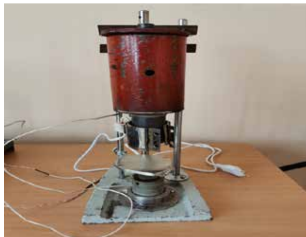
Рис. 4. Зовнішній вигляд установки з визначення контактної теплопередачі тепла від нагрівального циліндра
